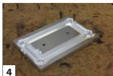
4 背面側の第一工程終了の段階。段々形がみえてきました。
