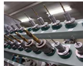
アルミを削るドリル。用途により大きさを変える
