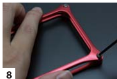
8 アルマイト終了後、すべて手作業で一個ずつ検品、組立、梱包します。
