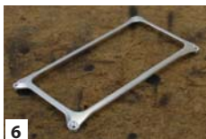
6 背面側が削りあがるまで約 20 分。液晶側面も同じ作業を繰り返します。
