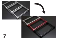
7 液晶面、背面の削りが終了するとアルマイト処理にて着色。
